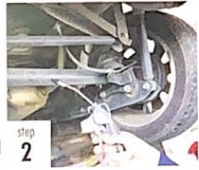
汚れをエアブロー
